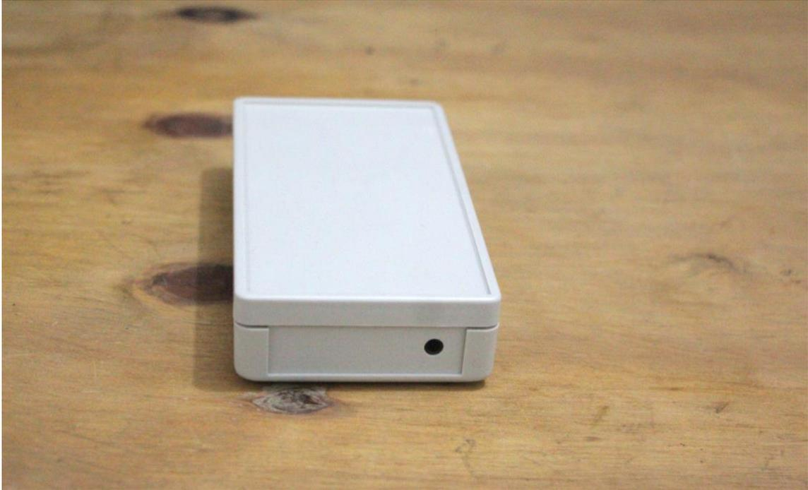
Figura 9 - Caixa fechada. Plug de conexão p2 em detalhe.
